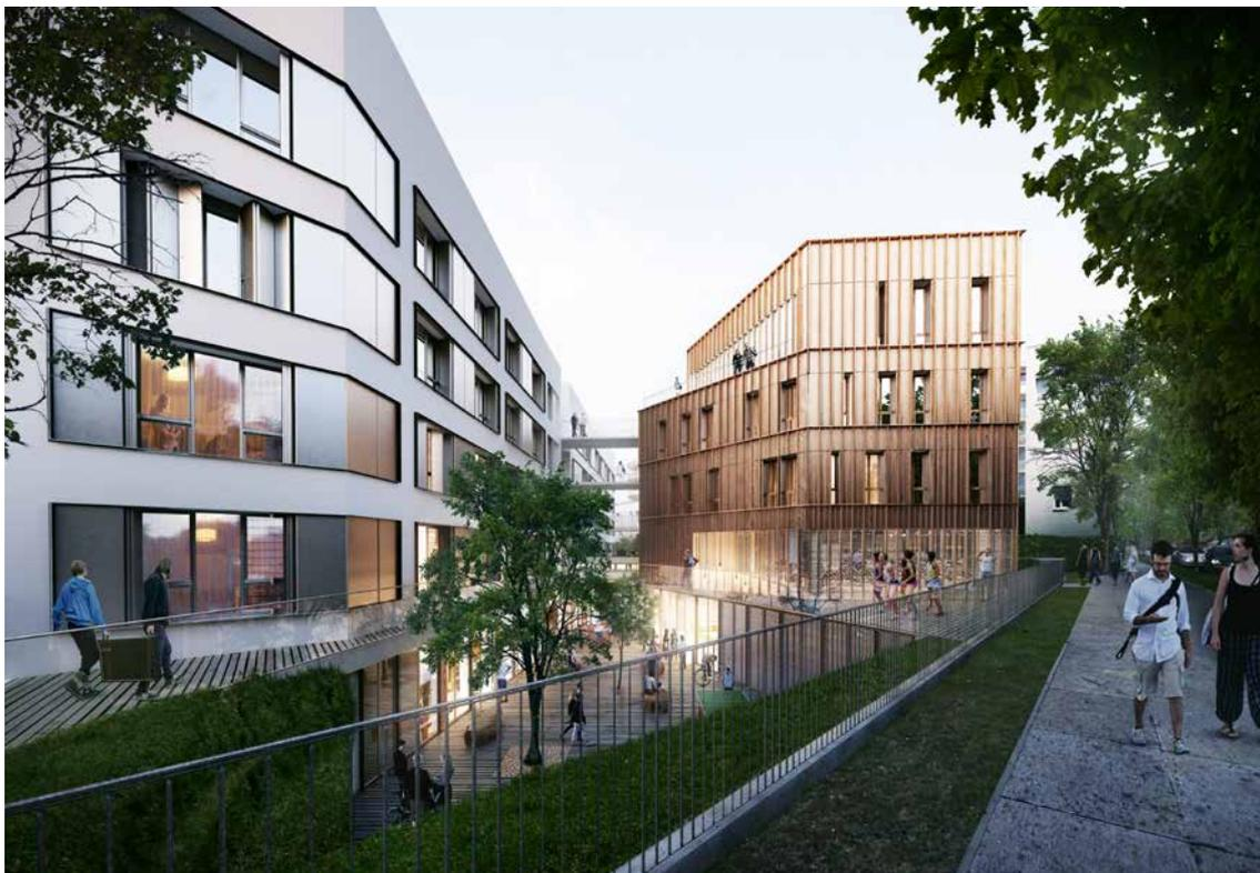
L'opération consiste en la restructuration d'un bâtiment avec une extension en bois isolée en paille, en vue de réaliser une résidence étudiante de 145 chambres.
