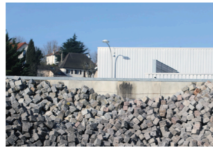
Plateforme de réemploi des matériaux de voirie de la Ville de Paris, Bonneuil-sur-Marne, Val-de-Marne. Photographies prises par Amor Immeuble et Anna Saint Pierre dans le cadre de la recherche en cours Pavés dormants , projet lauréat de « Faire Paris 2023 ». © Amor Immeuble / Anna Saint Pierre.
