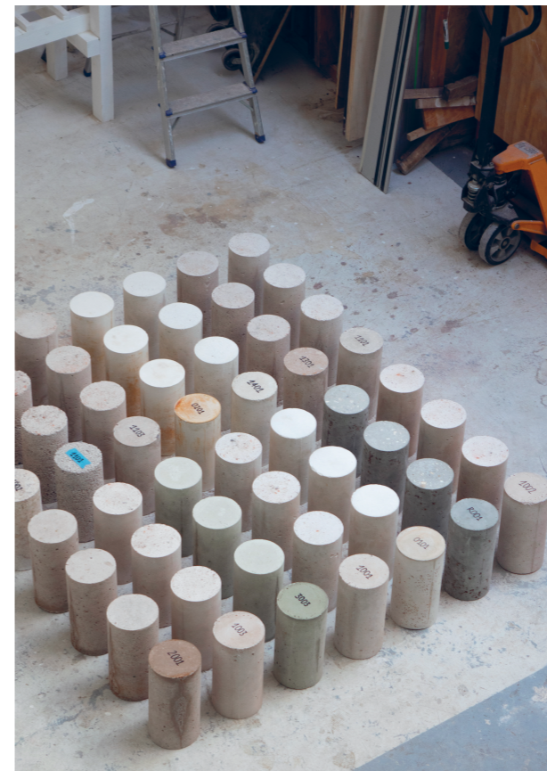
Campagne d'essais : Série d'éprouvettes cylindriques pour essais de compression après une cure de 28 jours, avant expédition au laboratoire de l'université Gustave-Eiffel. Atelier ciguë, septembre 2020.
