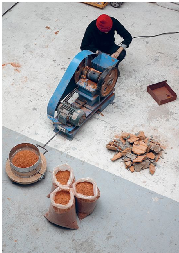
Transformation : Concassage et criblage des gravats issus du chantier de démolition avant fabrication des éprouvettes en atelier. Atelier ciguë, Montreuil, septembre 2020.
