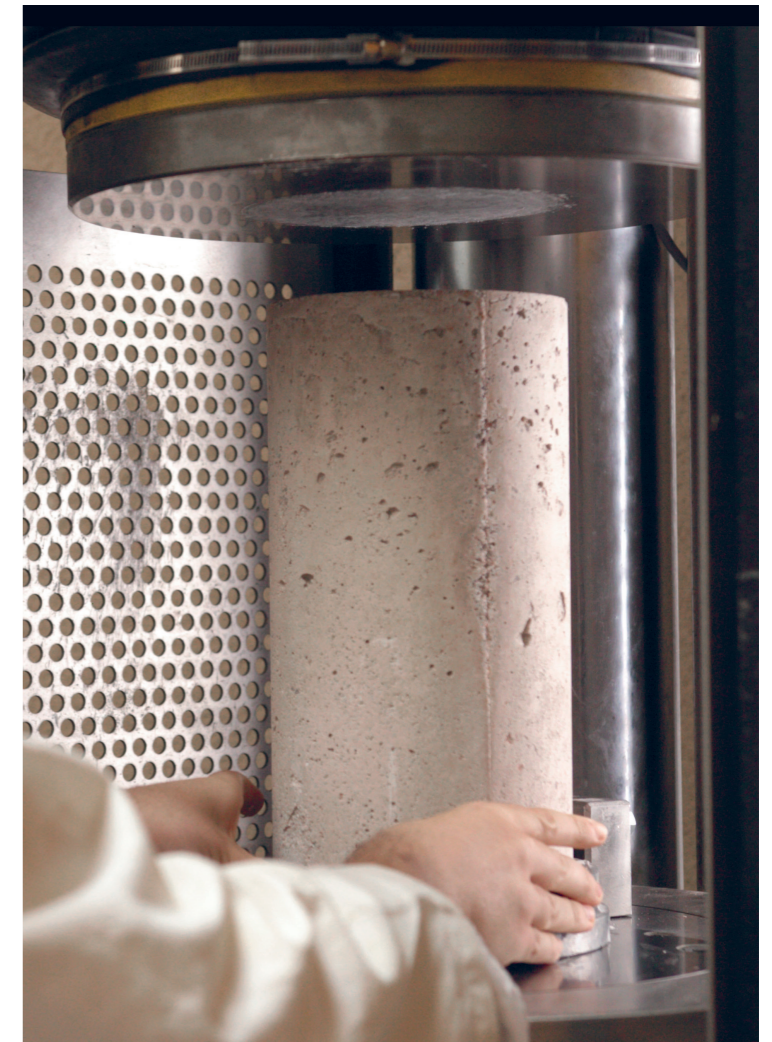
Essai de compression : échantillon de plâtre à plancher cylindrique soumis à un essai de compression sous presse jusqu'à rupture du matériau pour détermination de la résistance mécanique, laboratoire Granulats et procédés d'élaboration des matériaux de l'université Gustave-Eiffel, Nantes, septembre 2020.
