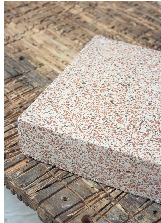
Formulation. Matériau de chape en béton de plâtre à 50 % de granulats de briques et de tuiles pour 50 % de plâtre à plancher standard. Atelier ciguë, Montreuil, septembre 2020.
