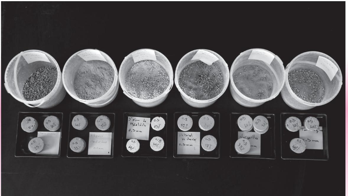
(12) La lecture globale des échantillons et des pastilles permet d'une part d'évaluer la palette chromatique à disposition et d'autre part de comparer les retraits des différentes terres correspondant aux potentialités des matériaux.
