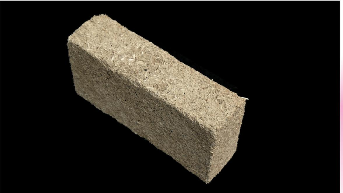
(28) Brique moulée à l'état plastique dit Adobe. Matériau mi-lourd, constitué d'un mélange gravo-argileux et de paille de blé hachée, utilisé en remplissage d'ossature bois ou en cloisonnements.
