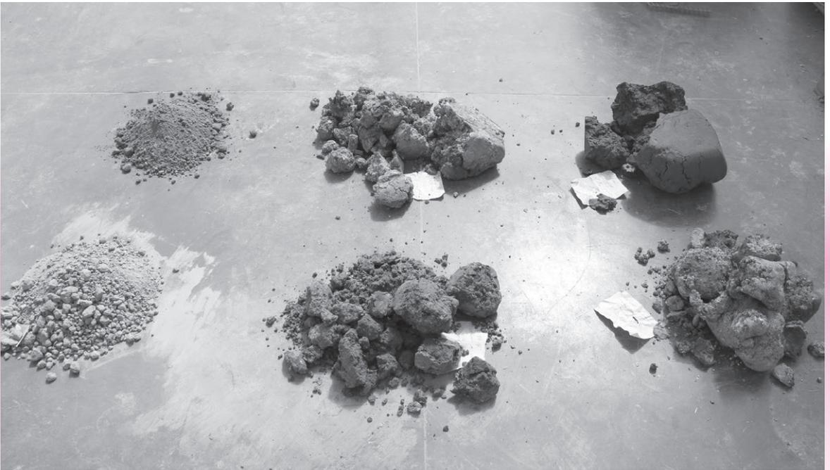
(7) En parallèle, les terres sont appréciées visuellement pour déterminer celles nécessitant un séchage.
