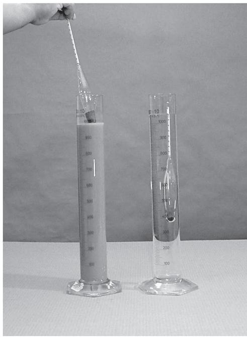
(10) Les particules fines issues du test de granulométrie sont ensuite soumises au test de sédimentométrie. Ce test consiste à placer les particules en suspension dans de l'eau et à mesurer leur vitesse de sédimentation. Les sables très fins et limons tombent successivement au fond tandis que les argiles restent longtemps en suspension.
