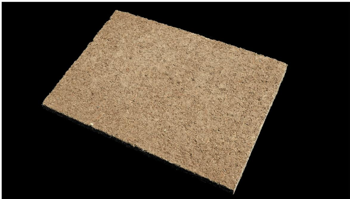
(25) Panneau de terre coulée poncé après séchage. Matériau mi-lourd constitué d'un mélange gravelo-argileux et de chènevotte (chanvre) permettant de réaliser des cloisons et des doublages par exemple.
