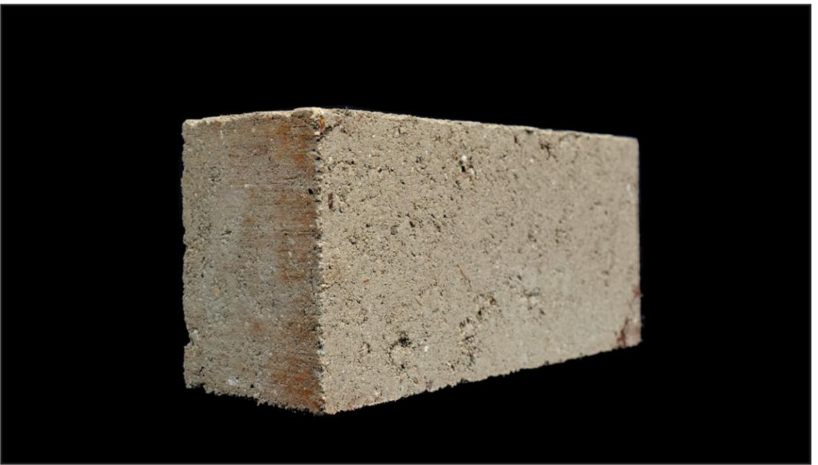
(26) Brique de terre comprimée appelée BTC. Matériau dense constitué d'un mélange gravo-argileux permettant de réaliser notamment des parements de façade.
