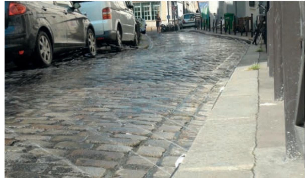
Utilisation du réseau d'eau non potable de la ville de Paris pour arroser la chaussée afin d'abaisser la température des rues.
